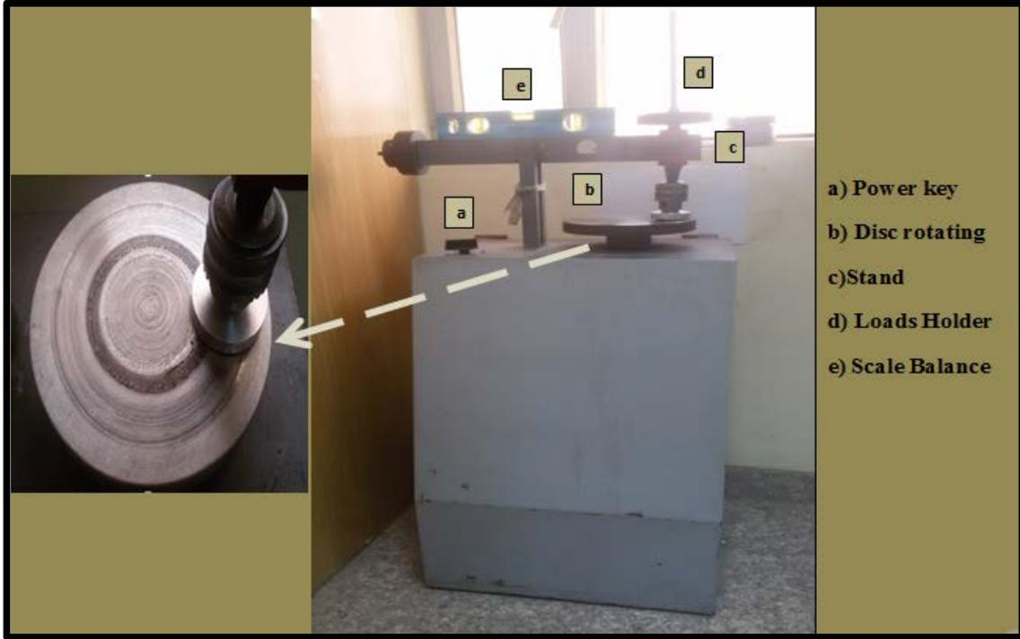
الشكل (12-3) صورة لجهاز قياس البلى
