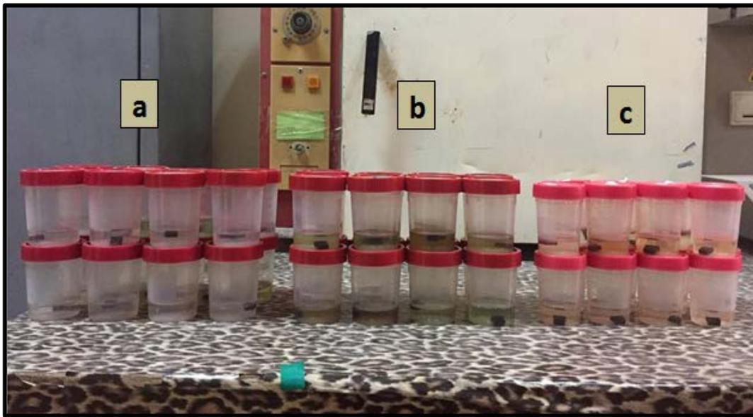
الشكل (3-15) صورة لعينات الامتصاصية بتأثير (a) الماء الاعتيادي (b) سائل التنظيف (الزاهي) (c) ماء جافيل (القاصر)
