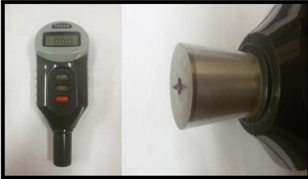
الشكل (3-11) صورة فوتوغرافية لجهاز قياس الصلادة (Shore -D)
