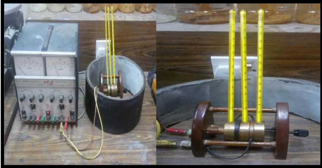
الشكل (3-13) منظومة قياس التوصيلية الحرارية
