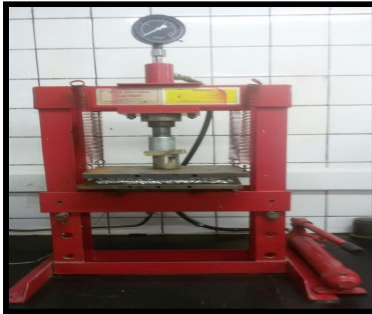
الشكل (3-8) صورة فوتوغرافية للمكبس النصف الي اثناء عملية الكبس.
