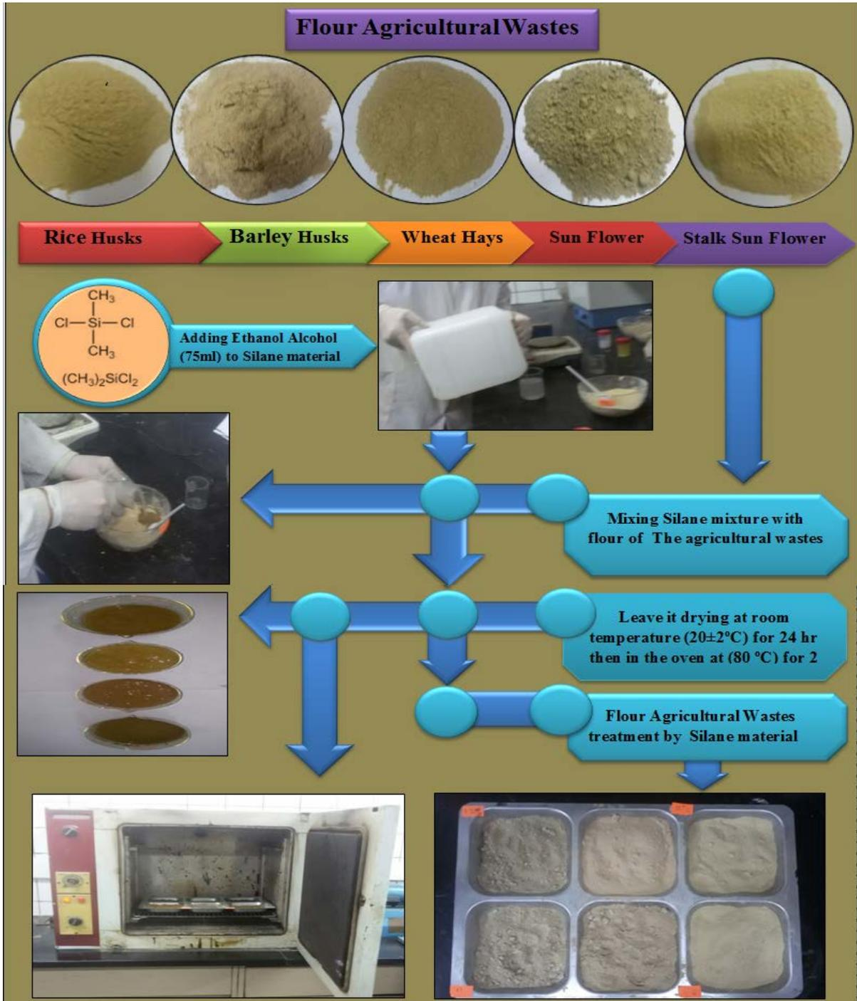
الشكل (3-4) مخطط توضيحي عن مراحل عملية معاملة مسحوق المخلفات الزراعية بالمادة الرابطة السيلانية (Dimethyldichlorsilane).
